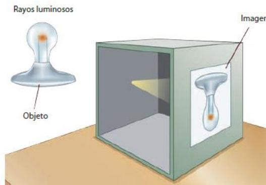
**Figura 3.3.** Formación de imágenes en una cámara oscura
